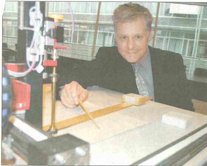
Dr. Ryszard Moroz führt den Radierroboter vor. Er erleichtert die Reinigung der Papieroberfläche. Fotos: Nicole Koch
